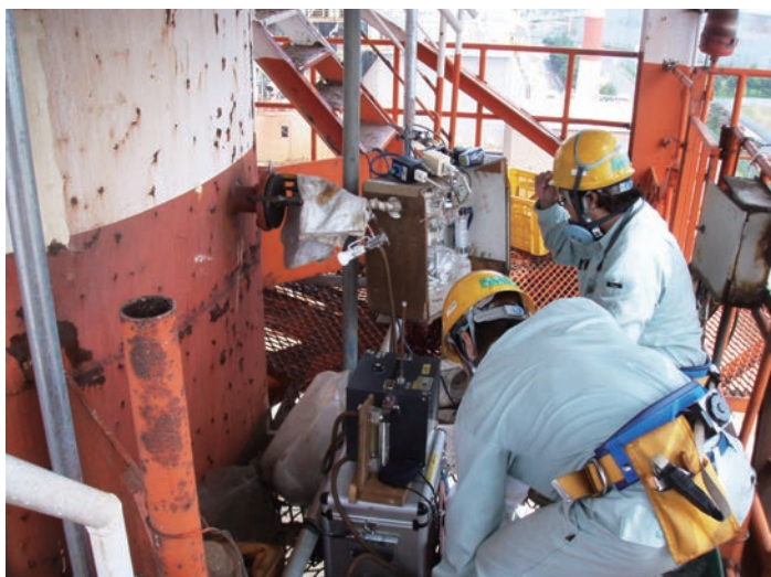
煙突でのばい煙測定
