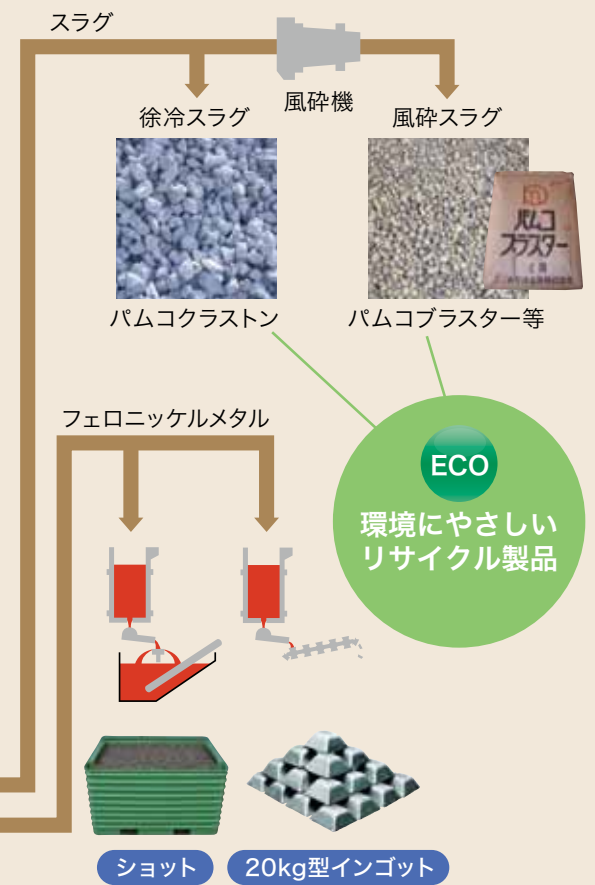
ショット鑄造： 溶湯を水槽内の水で急冷し、小さな粒状に仕上げます。 インゴット鑄造： 溶湯を鑄型に流し込んで20kgのインゴットに仕上げます。
