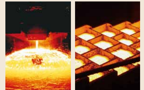
ショット鑄造： 溶湯を水槽内の水で急冷し、小さな粒状に仕上げます。 インゴット鑄造： 溶湯を鑄型に流し込んで20kgのインゴットに仕上げます。
