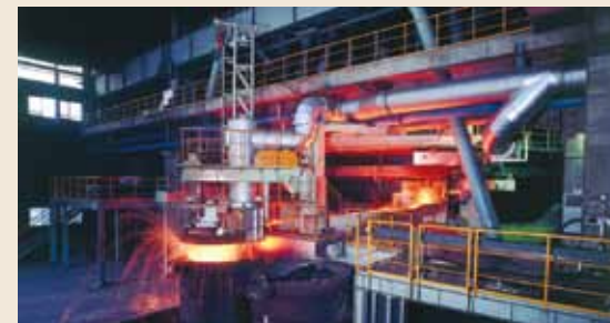
フェロニッケル製錬電気炉： 世界最大級の電気炉であり、 鉬石等を約1,500度の熱で 溶かし、フェロニッケルを製 錬します。
