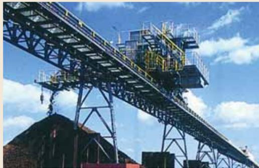
鉱石運搬コンベア：荷下りし終わった鉱石等を、全長2.4kmに及ぶコンベアで工場まで運びます。
