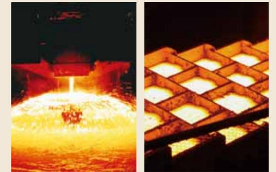
ショット鑄造：溶湯を水槽内の水で急冷し、小さな粒状に仕上げます。
