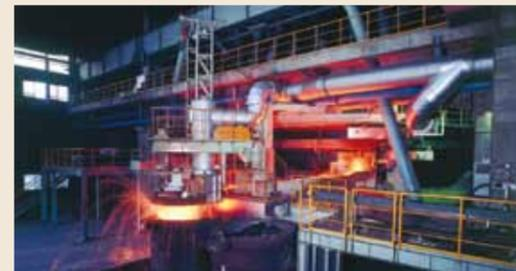
フェロニッケル製錬電気炉：世界最大級の電気炉であり、鉱石等を約1,500度の熱で溶かし、フェロニッケルを製錬します。
