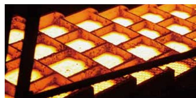
インゴット鋳造：溶湯を鑄型に流し込んで20kgのインゴットに仕上げます。
