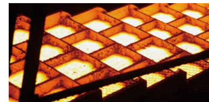
インゴット鑄造 ：溶湯を鑄型に流し込んで20kgのインゴットに仕上げます。
