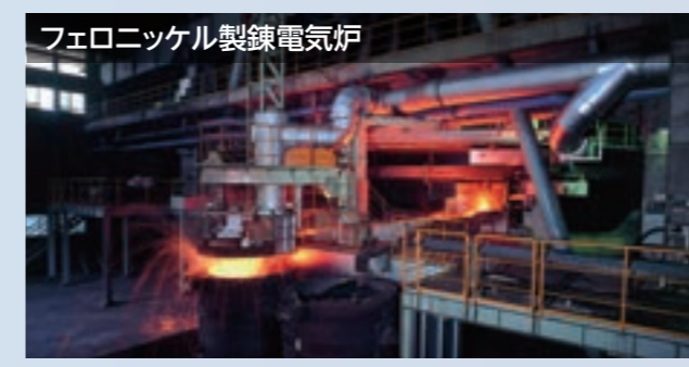
世界最大級の電気炉であり、鉱石等を電気抵抗熱で溶かし、フェロニッケルを製錬します。
