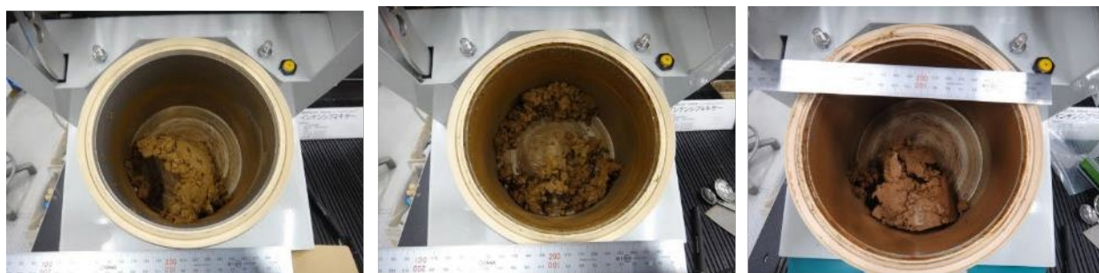
図 3-19 試験後のパン内の試料の様子 (C 鉱石) (篩下産物結果)
