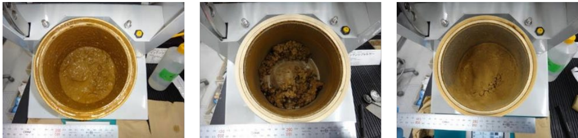
図 3-23 試験後のパン内の試料の様子 (C 鉱石) (篩下産物結果) 左 : パルプ濃度 66%、中央 : 80%、右 : 100%
