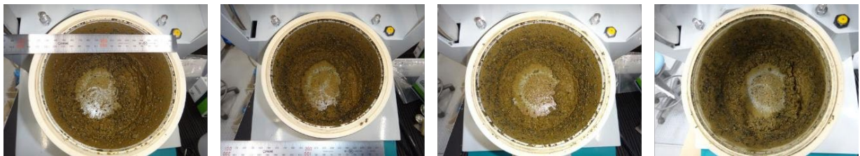
図 3-21 試験後のパン内の試料の様子 (D 塊鉱石(Fine)) (篩下産物結果) 左から : 1500rpm、3000rpm、6000rpm、7000rpm
