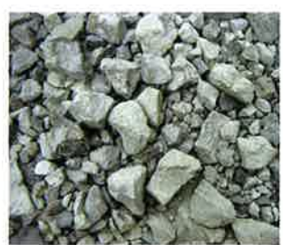
大平洋金属株式会社 パムコクラストン(電気炉徐冷スラグ)
