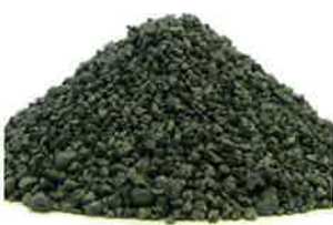
株式会社日向製錬所 グリーンサンド(電気炉水砕スラグ)
