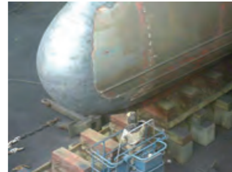
船首部分の研掃作業
