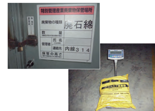
石綿の保管状況
