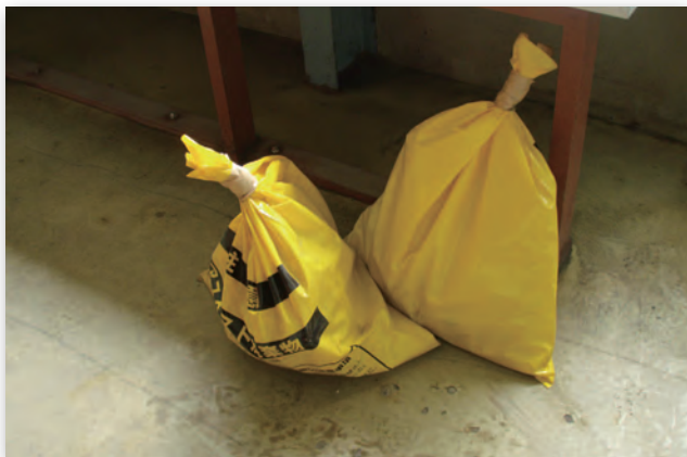
鍵のかかった保管場所で管理されている石綿
