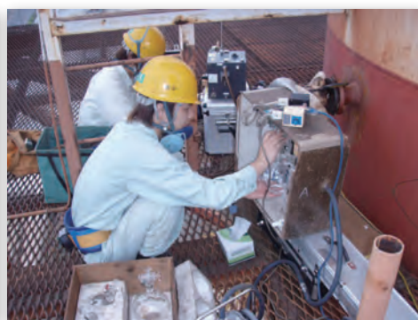
煙突におけるばい煙測定
