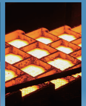
インゴット鑄造：溶湯を鑄型に流し込んで20kgのインゴットに仕上げます。
