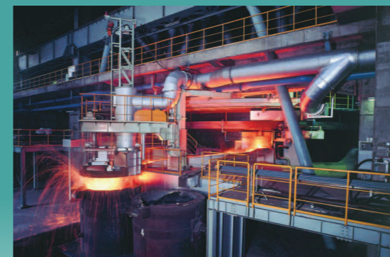
フェロニッケル製錬電気炉：世界最大級の電気炉であり、鉱石等を約1,500度の熱で溶かし、フェロニッケルを製錬します。
