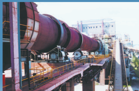
ロータリーキルン：全長100mを超える煅焼設備であり、乾燥した鉱石等を約1,000度まで熱し、熱処理します。
