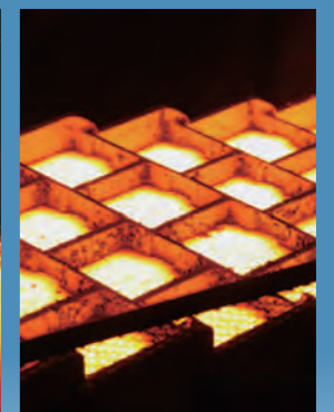
インゴット鋳造：溶湯を鑄型に流し込んで20kgのインゴットに仕上げます。
