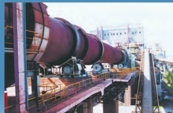
ロータリーキルン：全長100mを超える煅焼設備であり、乾燥した鉱石等を約1,000度まで熱し、熱処理します。
