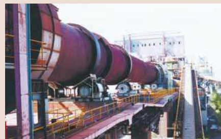
ロータリーキルン：全長100mを超える煅焼設備であり、乾燥した鉍石等を約1,000度まで熱し、熱処理します。
