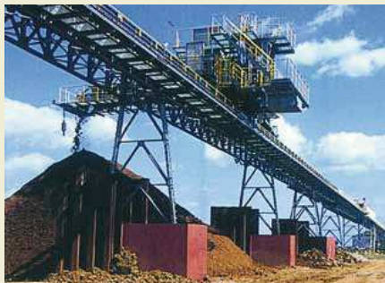
鉍石運搬コンベア：荷下ろしが終わった鉍石等を、全長2.4kmに及ぶコンベアで工場まで運びます。
