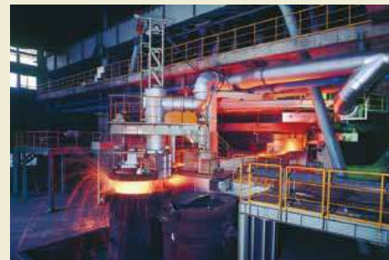
フェロニッケル製錬電気炉：世界最大級の電気炉であり、鉍石等を約1,500度の熱で溶かし、フェロニッケルを製錬します。
