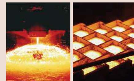
ショット鑄造：溶湯を水槽内の水で急冷し、小さな粒状に仕上げます。 インゴット鑄造：溶湯を鑄型に流し込んで20kgのインゴットに仕上げます。
