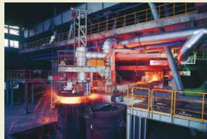
フェロニッケル製錬電気炉：世界最大級の電気炉であり、鉬石等を約1,500度の熱で溶かし、フェロニッケルを製錬します。
