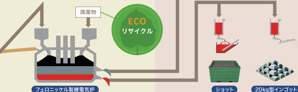
フェロニッケル製錬電気炉：世界最大級の電気炉であり、鉬石等を約1,500度の熱で溶かし、フェロニッケルを製錬します。
