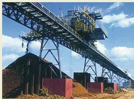
鉬石運搬コンベア：荷下ろしが終わった鉬石等を、全長2.4kmに及ぶコンベアで工場まで運びます。
