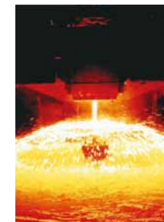
ショット鑄造：溶湯を水槽内の水で急冷し、小さな粒状に仕上げます。
