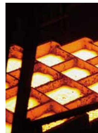
インゴット鑄造：溶湯を鑄型に流し込んで20kgのインゴットに仕上げます。
