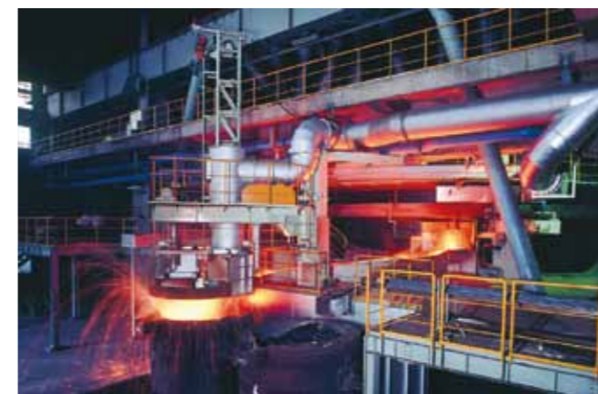
フェロニッケル製錬電気炉：世界最大級の電気炉であり、鉱石等を電気抵抗熱で溶かし、フェロニッケルを製錬します。
