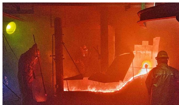
電気炉での多金属ノジュール製錬試験/ニッケル・銅・コバルト合金の出湯
