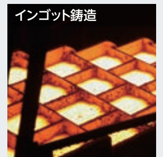
インゴット casting 溶湯を鋳型に流し込んで20kgのインゴットに仕上げます。
