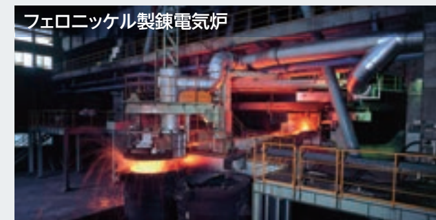
フェロニッケル製錬電気炉 世界最大級の電気炉であり、鉱石等を電気抵抗熱で溶かし、フェロニッケルを製錬します。
