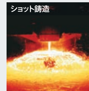
ショット casting 溶湯を水槽内の水で急冷し、小さな粒状に仕上げます。
