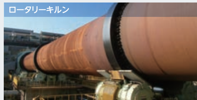
ロータリーキルン 全長100mを超える煅焼設備であり、乾燥した鉱石等を約1,000度まで熱し、熱処理します。
