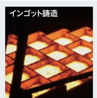
溶湯を鋳型に流し込んで20kgのインゴットに仕上げます。
