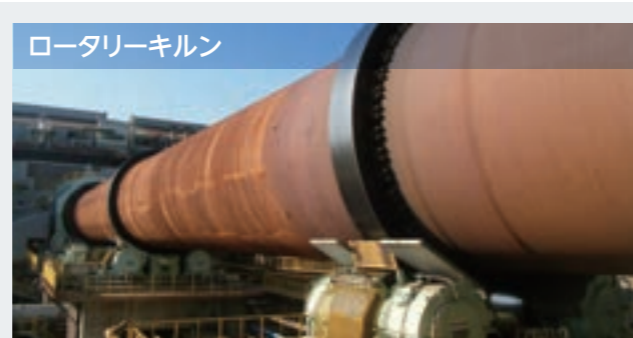
全長100mを超える煅焼設備であり、乾燥した鉱石等を約1,000度まで熱し、熱処理します。
